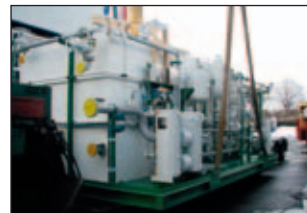
带 BFD-P型波尔双联滤器的压缩机站润滑油单元
