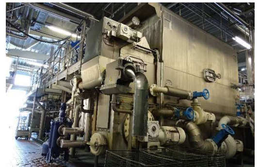
Fig. 2: Máquina de lavar garrafas KRONES modelo Lavatec KES 3-4, 46.000 garr/h
