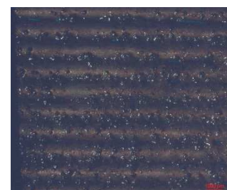
Bild 4: mit Belag verschmutztes Filterelement
