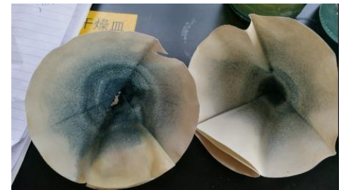
Ensayo de TSS realizado por el laboratorio de ABInBev antes y después de utilizar BOLLFILTER
