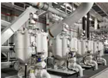
... zur Filtration von Kühlschmierstoffen in Werkzeugmaschinen
