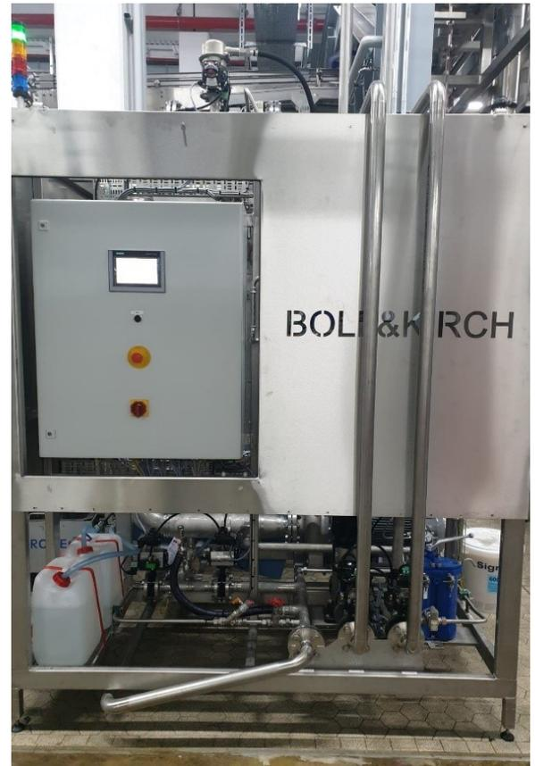
Die BOLL FFU BWM Mikrofiltration ist nach dem BOLLFILTER Automatik Typ 6.64 in der **Hauptlauge eingebunden** und versorgt einen Überschüttbalken in der Hauptlauge.
