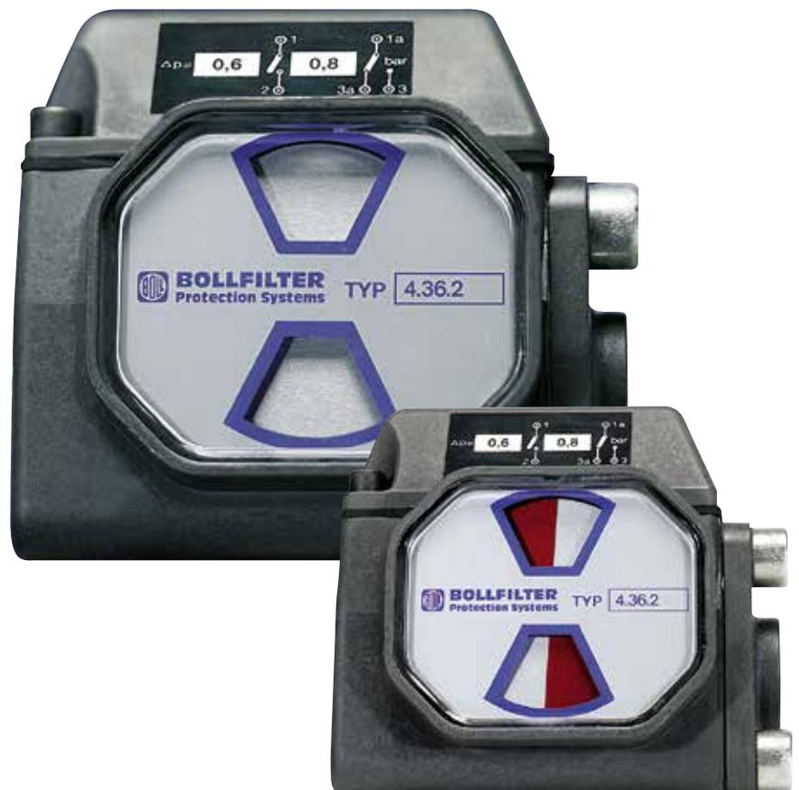
stehen zusätzlich zwei Schalter zur Verfügung, die unabhängig voneinander als Schalt- oder Alarmkontakt genutzt werden können. Bei 75 % und bei 100 % des eingestellten Differenzdruck-Grenzwertes werden die Kontakte der beiden Reed-Schalter magnetisch betätigt.
