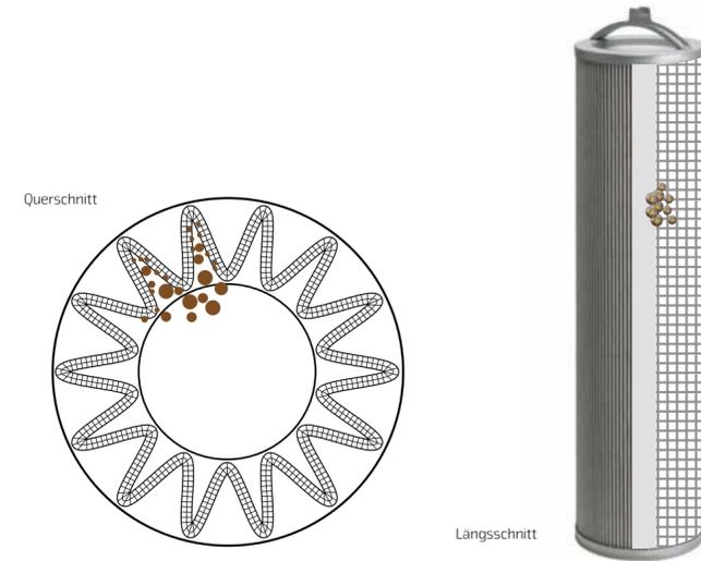
Da die Partikel tief im Vlies abgeschieden werden, ist ein Abreinen der Partikel nicht möglich. Das heißt, dass die Filterelemente bei einem bestimmten Differenzdruck ausgetauscht werden müssen. Auslegungskriterien sind neben den Gaskomponenten und den Betriebsparametern wie Volumenstrom, Druck und Temperatur auch die Abscheideleistung, der Differenzdruck und die zu erwartende Partikelmenge.
