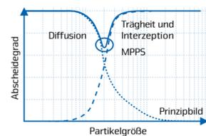
—Partikelabscheidemechanismen aus Gasen—
