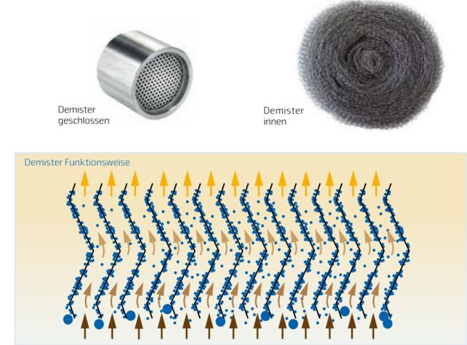
Bei einem Demister ist der hauptsächliche Abscheidemechanismus der Trägheitseffekt. Eine gute Abscheideleistung wird dabei über mehrmaliges Umlenken der Gasströmung im Demister erreicht. Die Partikel lagern sich an der Oberfläche des Drahtes im Demister ab und fließen aufgrund der Schwerkraft nach unten. Die Auslegung des Demisters ist neben den Betriebsbedingungen wie Volumenstrom auch abhängig von der Partikelart, dem abzuschneidenden Medium und der geforderten Abscheideleistung.
