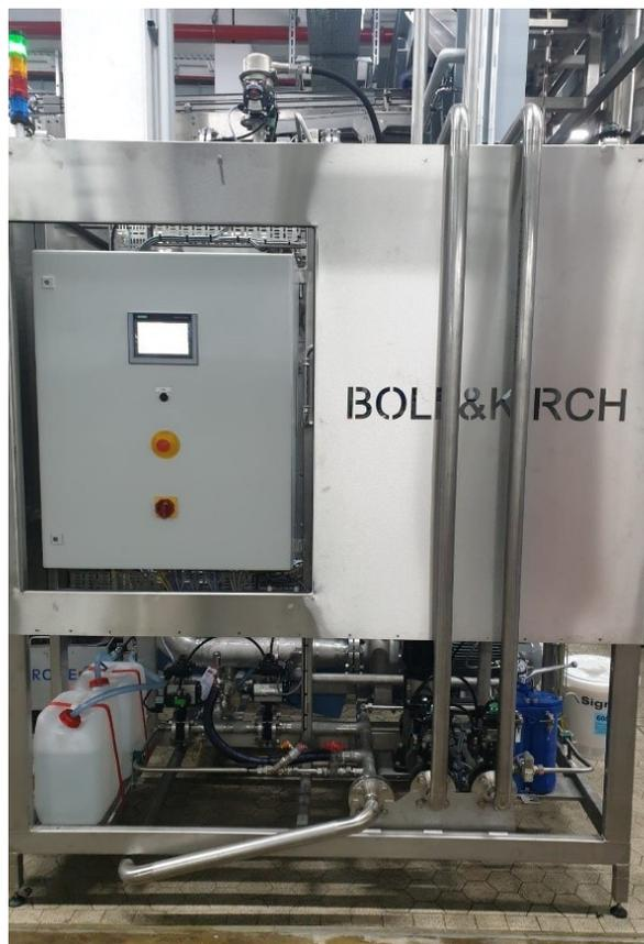
La microfiltración BOLL FFU BWM está integrada detrás del BOLLFILTER Automático tipo 6.64 a la lejía principal y suministra boquillas duchadas.
