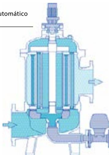
A aplicação principal deste filtro automático BOLLFILTER é a filtração de água. Por esse motivo, os componentes internos foram fabricados em aço inoxidável. A contralavagem totalmente automática do elemento filtrante é muito eficiente. O fluxo axial e longitudinal é gerado com elementos de tipo vela abertos em ambas as extremidades – Princípio de funcionamento bipolar.
