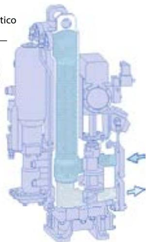
O filtro automático BOLLFILTER TIPO 6.72 foi desenvolvido especialmente para baixos caudais de combustíveis, óleos lubrificantes e refrigerantes. Seu design especial possibilita a filtração em até 6 microns. É possível integrar um filtro bypass com válvula de comutação utilizando-se o 6.72 como filtro principal.
