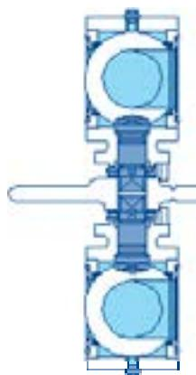
Válvula de esferas de três vias
